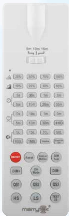
Profi Infrarot-Fernbedienung für IR-Bewegungsmelder UFO XII mit 31 Funktionen bis 15m Reichweite
