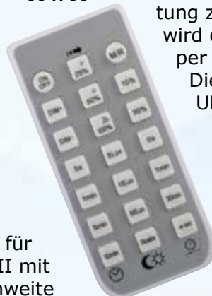
Mini Infrarot-Fernbedienung für IR-Bewegungsmelder UFO XII mit 17 Funktionen bis 6 m Reichweite
